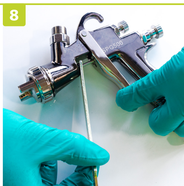
8 • Serrer le vis jusqu'à ce que l'aiguille ne bouge plus • Puis dévisser le vis jusqu'à ce que l'aiguille bouge un peu
