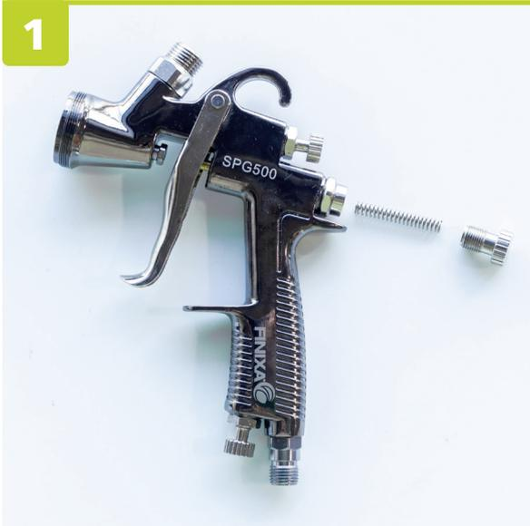
1 Schraube und Feder entfernen
