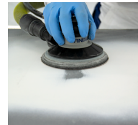
prebrúsiteľný vodca : ak niekto bude následne brúsiť a prebrúsi plnič objaví sa čierna farba ako upozornenie
